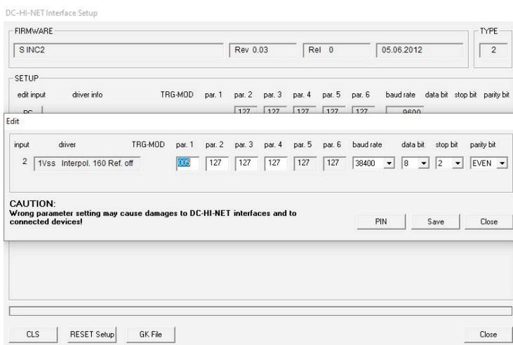
A visualização do sistema de medição no Metric agora é exibida na direção para a direita para Mais e na direção para a esquerda para Menos. Se for na direção oposta, você precisa reajustar a interpolação, sendo que é registrado o valor 037 em Par 1 respectivamente Par 2. Em seguida, aplicar/salvar os valores.
