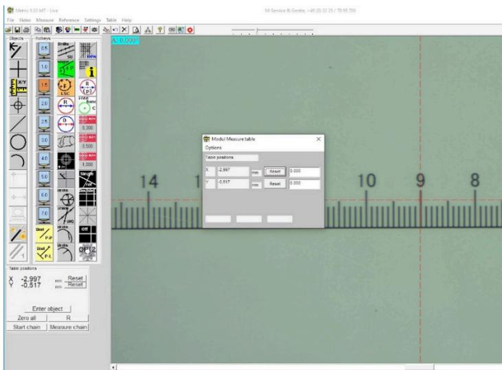
Ao exibir um valor incorreto da seção de medição, a interpolação da interface precisa ser ajustada novamente. O procedimento é o seguinte.
