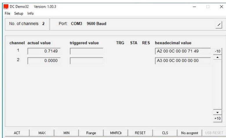
Em «Setup», ir para o item RS 232 Setup e selecionar a conexão COM correta. A conexão é estabelecida e os dados são transmitidos.
