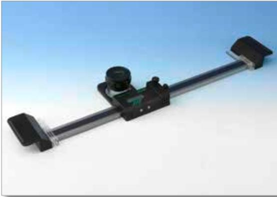
Usar uma escala eletrônica facilita as medições lineares. A guia em aço inoxidável endurecido possui uma banda indutiva. Deste modo, o sistema eletrônico dispõe da informação da posição momentânea do carro de medição, que corre sobre rolamentos de esferas axiais sem folga nem desgaste. O sistema óptico com quatro lentes revestidas com fator de ampliação de 10x permite aproximar com precisão ao ponto de medição.
