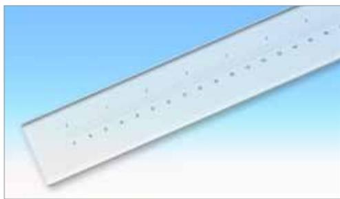
Ces règles de précision de la gamme Uniscale sont dotées de traits et de chiffres en chrome dur vaporisé. Graduation en mm et en pouce sur chaque règle. La plus petite graduation de l'échelle anglo-saxonne est 0,005". La plus petite graduation de l'échelle métrique est 0,1 mm. Les règles Uniscale sont similaires aux règles Chromscale et Micro-Chromscale, mais sans loupes, poignées ni bandes blanches... Elles s'adaptent parfaitement aux systèmes conçus par vos soins.
