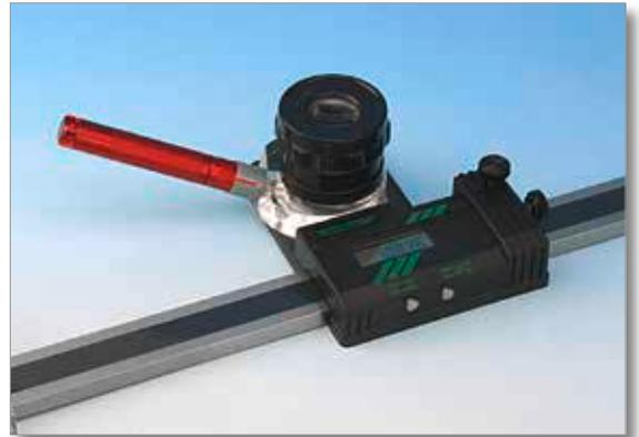
La représentation des données sur ordinateur se fait dans Excel avec le logiciel fourni en option. Les deux coulisseaux latéraux de positionnement facilitent le réglage rapide et parallèle de la graduation par rapport à l'objet à mesurer.
