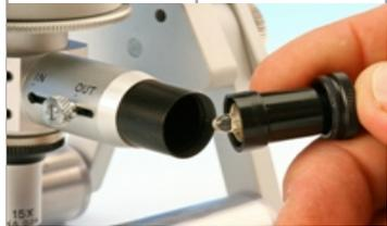
Módulo plug-in con espejo translúcido para iluminación coaxial para serie 2034-CIL, 2064-CIL y Cellcheck CIL
